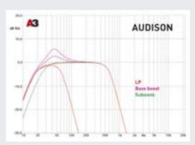
Фильтр НЧ — с крутизной 24 лБ/окт, и абсолютно стабильны ми характеристиками, частота среза меняется от 55 до 550 Гц. У сабсоника крутизна 18 дБ/окт., фактическая частота среза — 27 Гц. Выключение сабсоника на самом деле означает изменение частоты его среза с 27 Гц на 22 Гц при сохранении той же крутизны, отражения этого обстоятельства в инструкции мы не нашли. Бас-буст по итальянской традиции сделан крайне деликатно, центральная частота 45 Гц, подъём — 3 или 6 дБ, как и было задумано.
